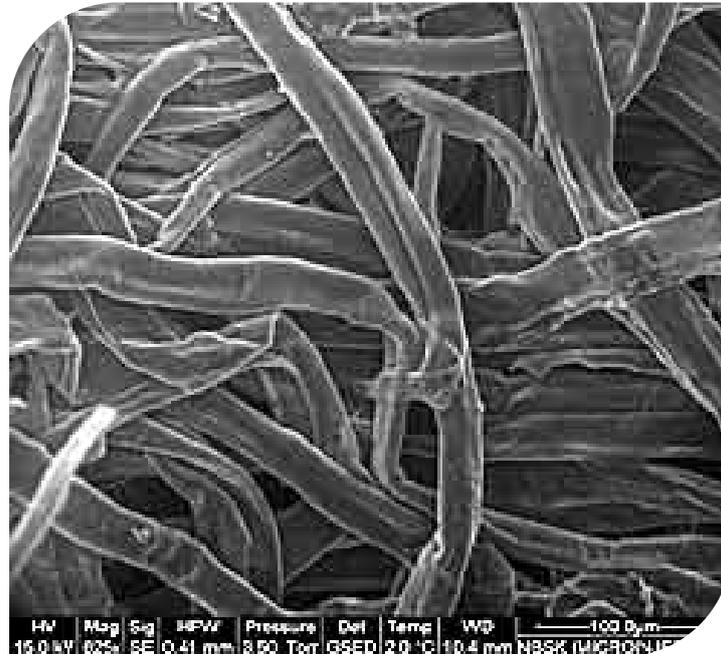
Fibre papier vue au microscope électronique
