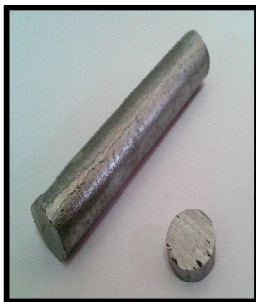
FigureIV.3. C) La barre obtenus par moulage, D) Copeauxobtenus par chariotage.
