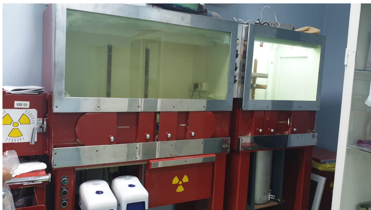
Figure 34 : Hotte blindée du laboratoire chaud.
