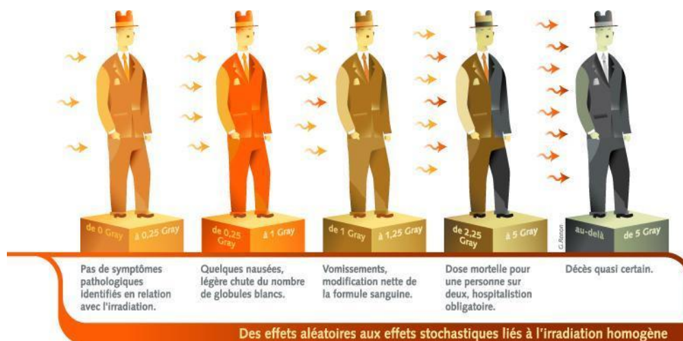
Figure 17 : Tableau des effets sur l'organisme en fonction des doses pour une irradiation globale (corps entier). (38)
