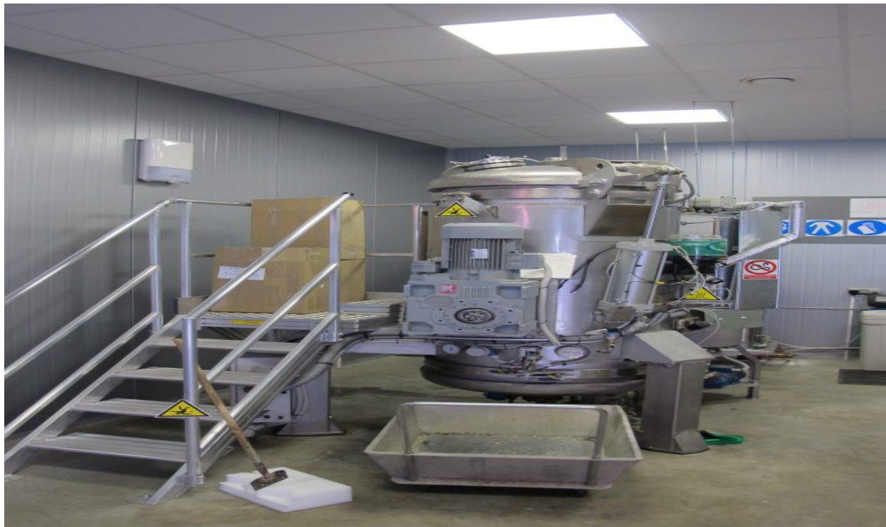
Figure 5 : Broyeur ECODAS T300 pour déchets hospitaliers
