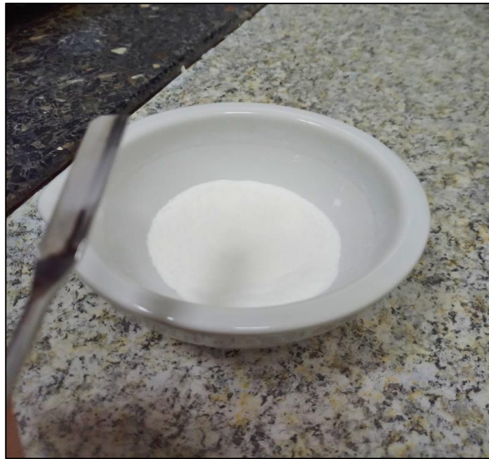
Figure 39 : poudre fine après broyage des comprimés de produit 1
