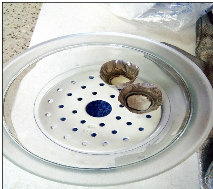
Figure 43 : Les 2 creusets après chauffage sont refroidis dans un dessiccateur
