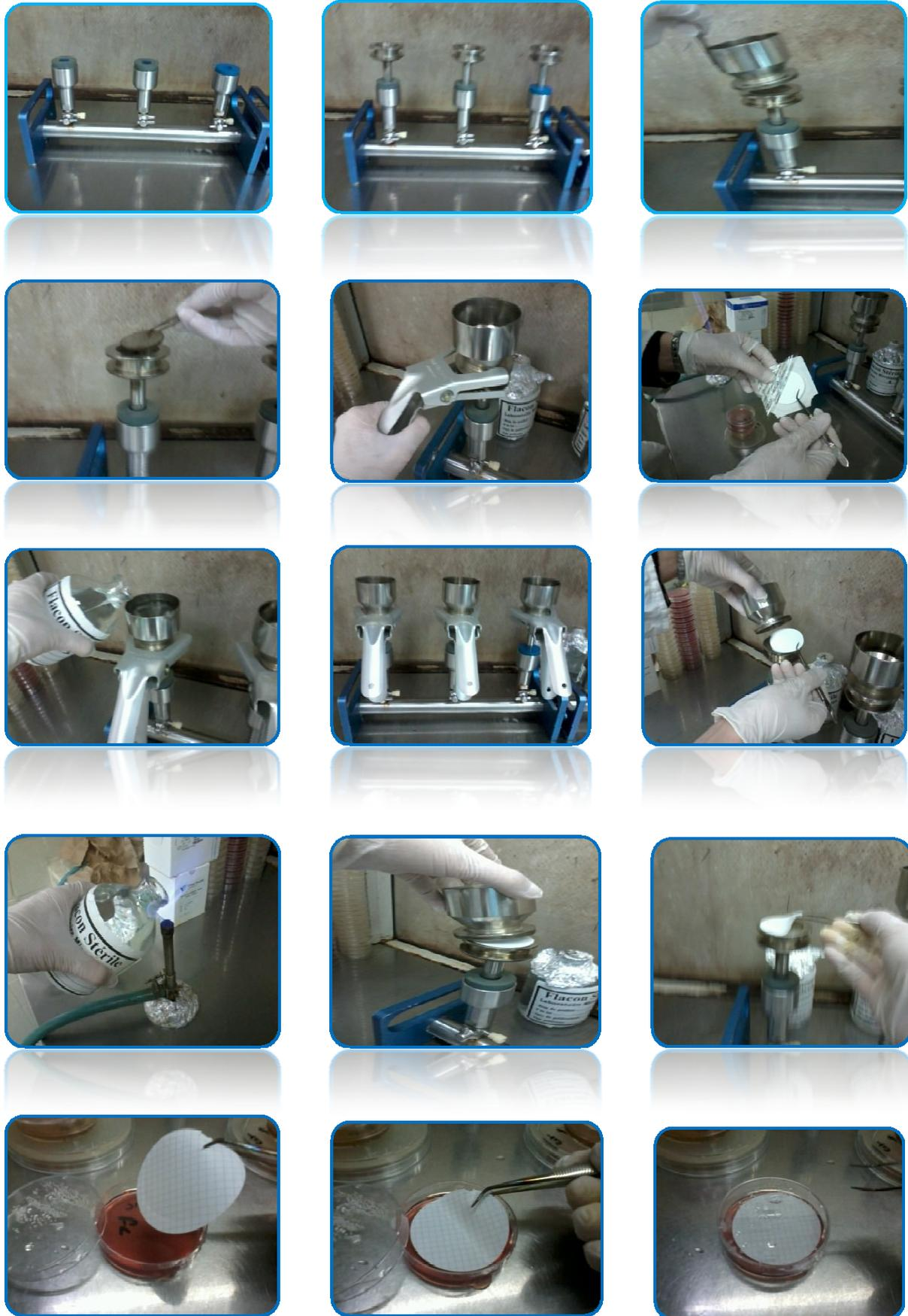
**Figure 26 : Etapes de filtration sur membrane (de gauche à droite) (photos originales)**
