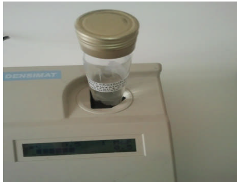
Densitomètre avec un inoculum à 0,5 Mc Ferland.
