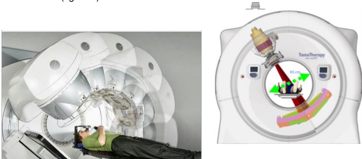
Figure 8 : Principe de la radiothérapie VMAT (gauche) et de la tomothérapie hélicoïdale (droite). 33
