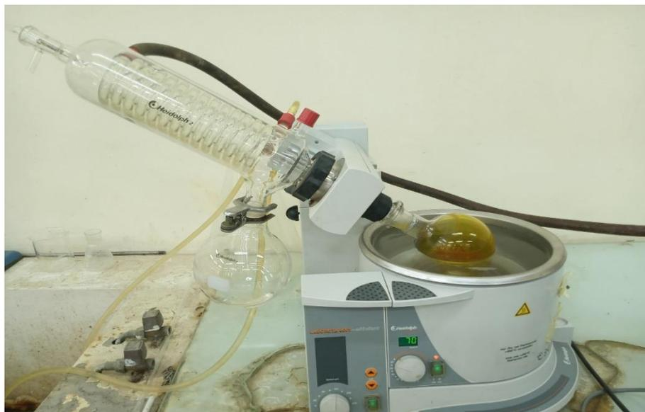
**Figure 11:** évaporation de l'éthanol de l'extrait de Curcuma par le rotavapeur
