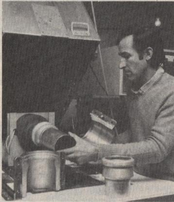
Le formage électromagnétique permet d'obtenir des pièces complexes à partir d'une plaque ou d'un tube placé entre la matrice de la pièce souhaitée et une bobine d'induction. Avantages : de grandes vitesses de formage, des assemblages très précis – certains même impossibles à réaliser par soudage – ainsi qu'une bonne résistance.
