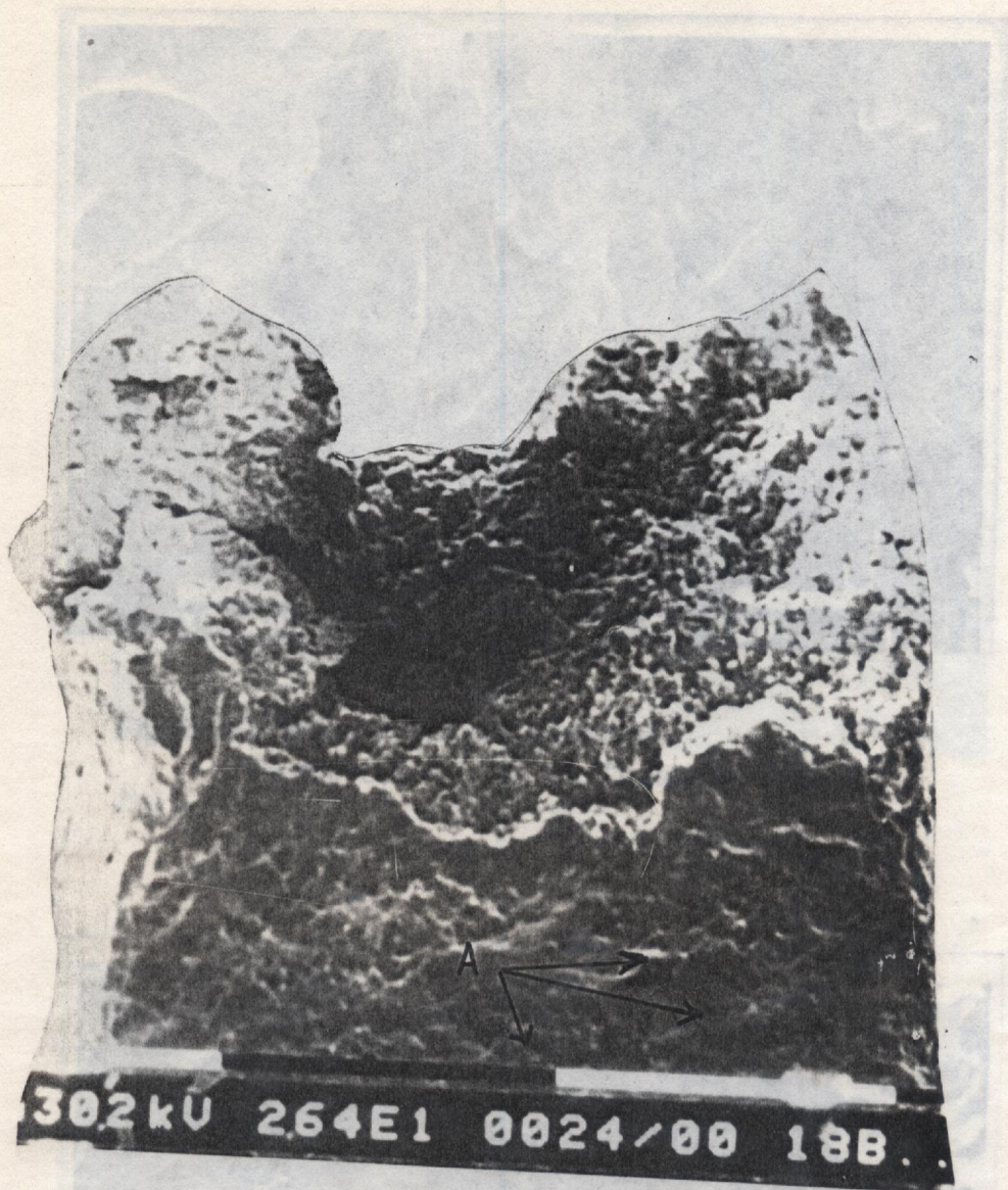
Fig (19) Aspect de la rupture à haute température T = 480^{\circ}\text{C} , \dot{\epsilon} = 6 \times 10^{-4} \text{ 1/s} , Traitement TR
