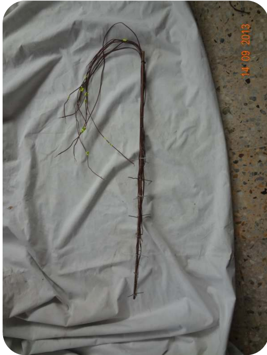
Figure IV.11 : Thermocouple collés sur une tige.
