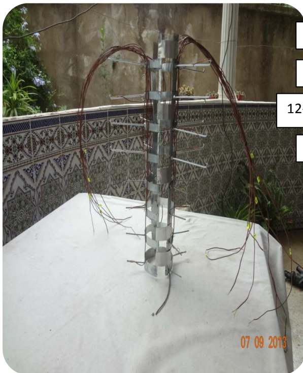
Figure IV.9: Le support des TC de la cuve.
