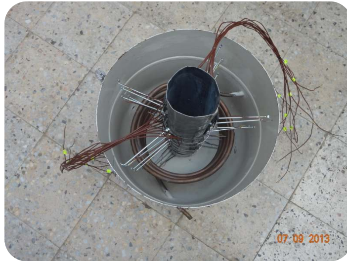
Figure IV.8 : Le montage de support des thermocouples dans la cuve.
