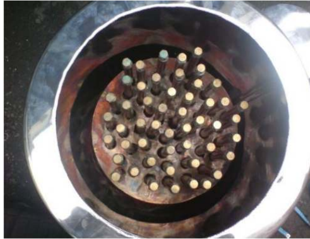
Figure I.10: L'unité de stockage fabriqué. B.Kanimozhi, B.R.Ramesh (2012).[17]
