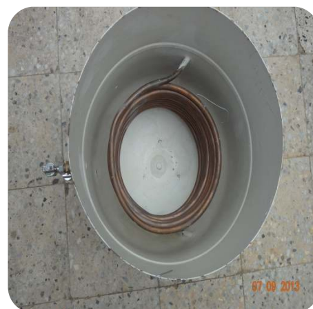
Figure IV.7 : L'emplacement de l'échangeur de chaleur.
