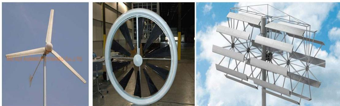
Figure 1.9 Les éoliennes à axe horizontal
