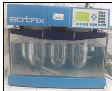
Figure A4 12: Dissolustest SOTAX.
