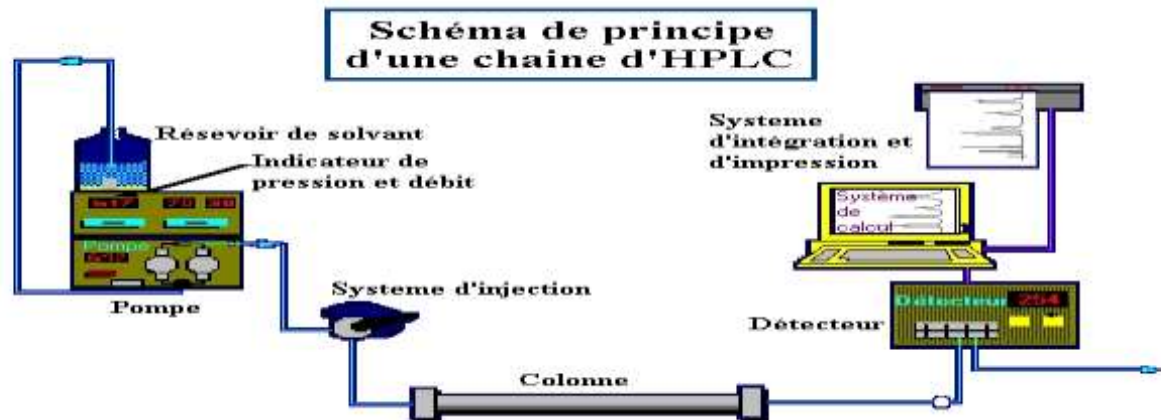
Figure N°5: schéma de principe d'une chaîne d'HPLC.
