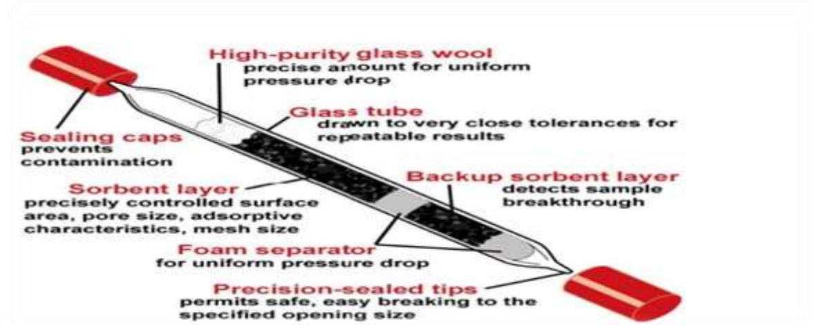
Figure N°2: Exemple d'un support adsorbant pour le prélèvement actif.
