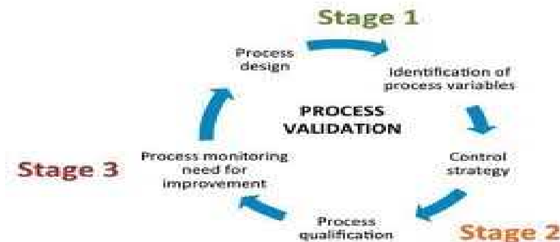
Fig.05 : schéma illustrant les étapes de la validation de processus de fabrication selon FDA[27]
