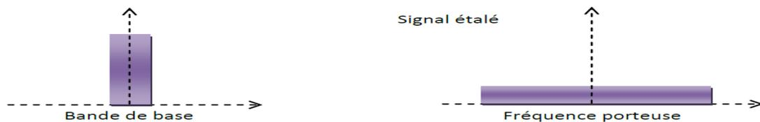
**Figure 2.7.** Principe de l'étalement de spectre.
