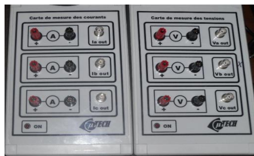
Figure 4.4 Photo des capteurs de tension et du courant.
