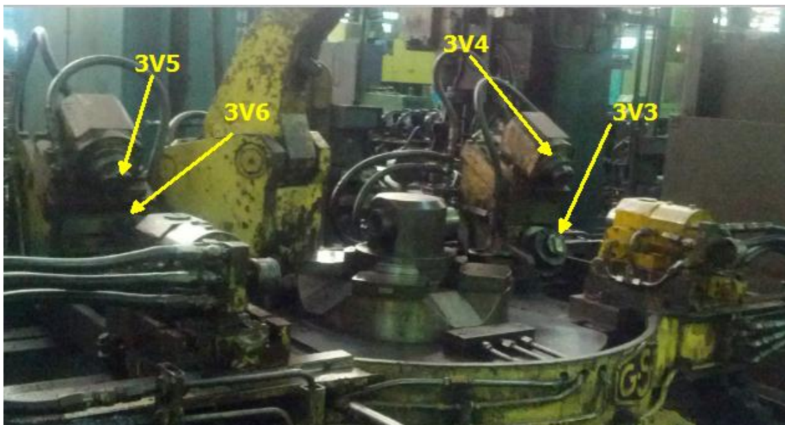
Figure 2.15 : Les vérins commandés par EV8.
