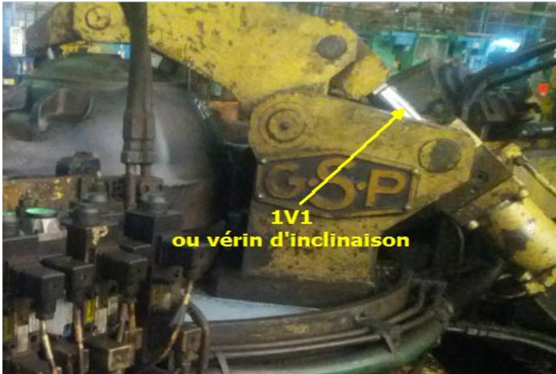
Figure 2.13 : Vérin 1V1 commandé par EV3.
