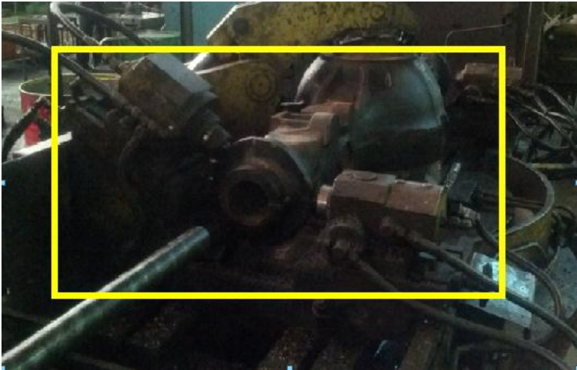
Figure : bridage et usinage côté gauche de la pièce
