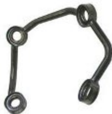
Figure I.12- forme d'un bâti Dynafocal [8]
