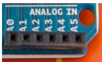
Fig. II.3.6 les Broches analogiques de la carte arduino-uno
