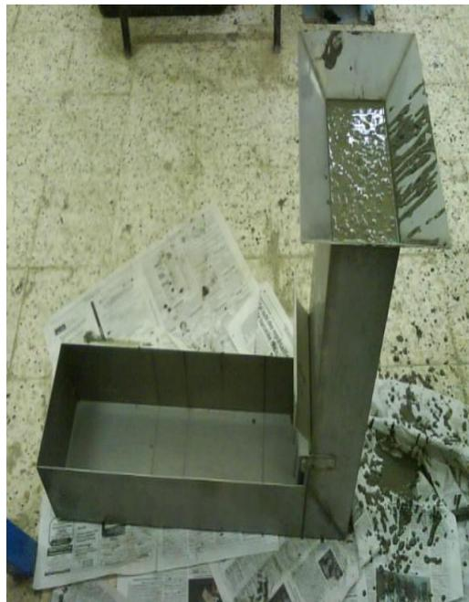
*Figure 2.11: essai d'écoulement*
