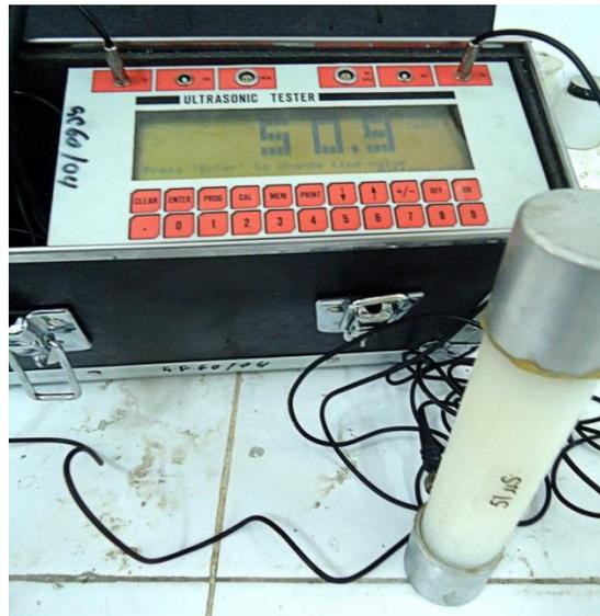
*Figure 2.16 : Etalonnage de l'ultrason à l'aide du barreau de calibrage.*
