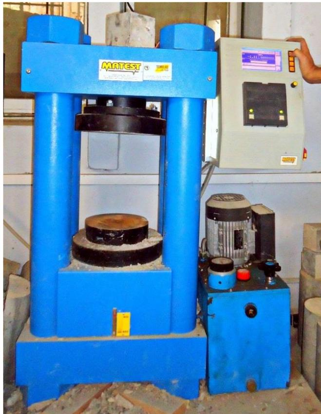
*Figure 2.7 : Presse hydraulique*
