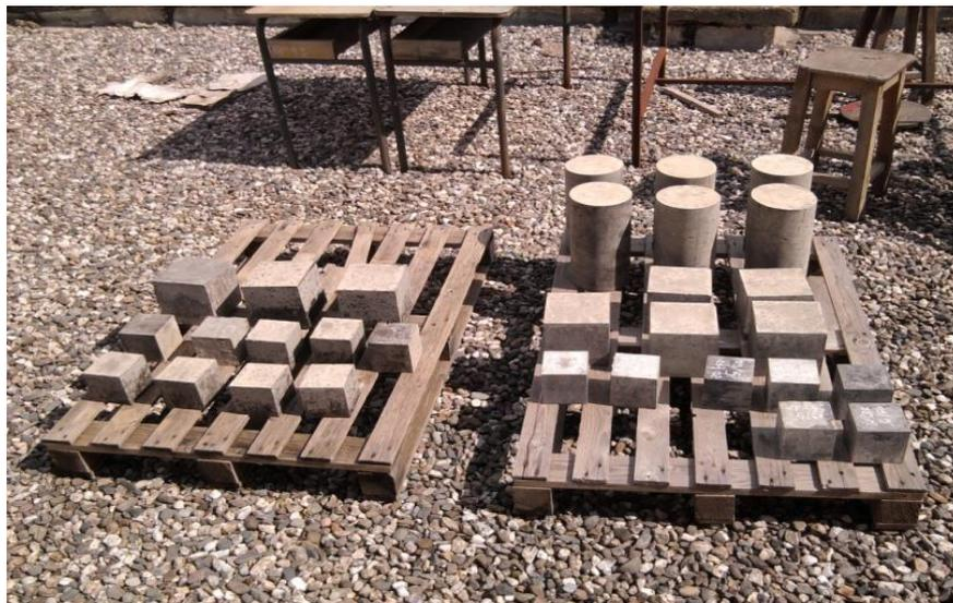
*Figure 2.13: Éprouvettes conservées à l'air libre*
