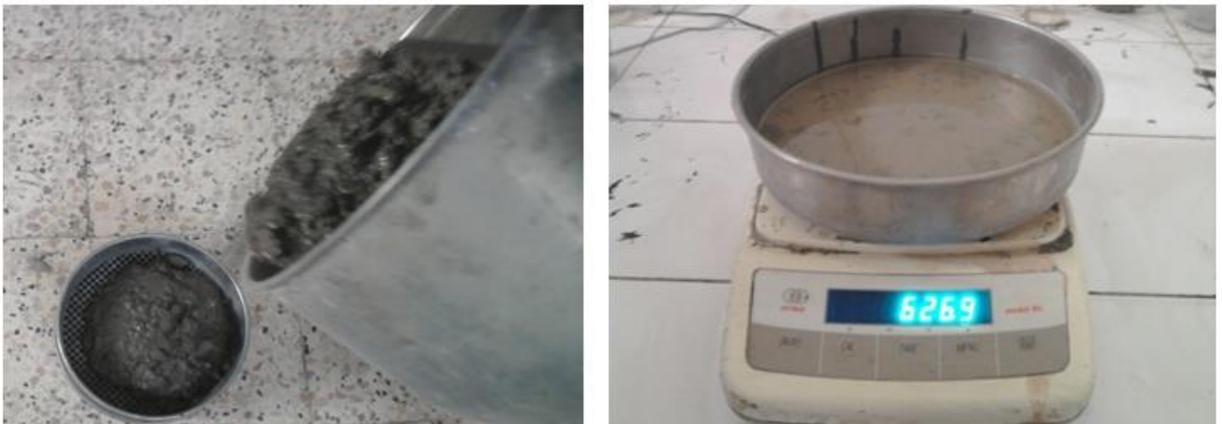
*Figure 2.12 : Essai au tamis.*
