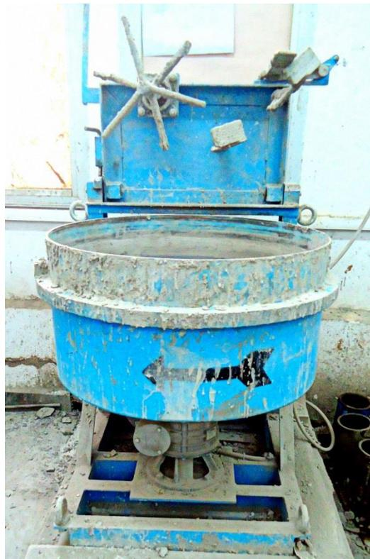
*Figure 2.9 : Malaxeur de béton*
