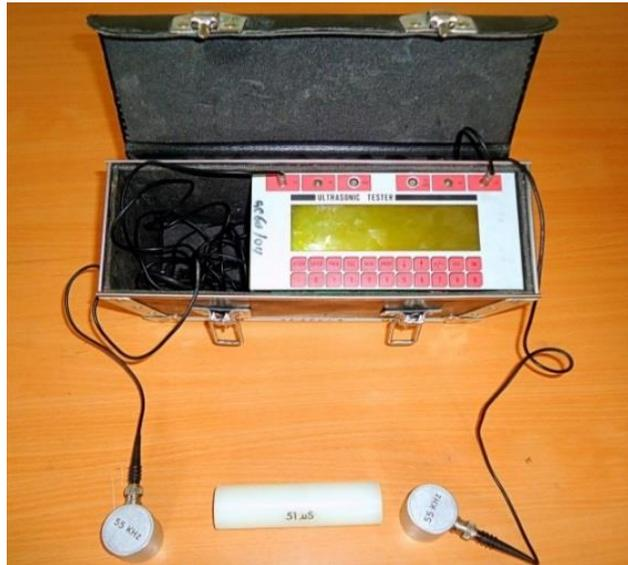
*Figure 2.6 : Appareil de l'ultrason utilisé.*
