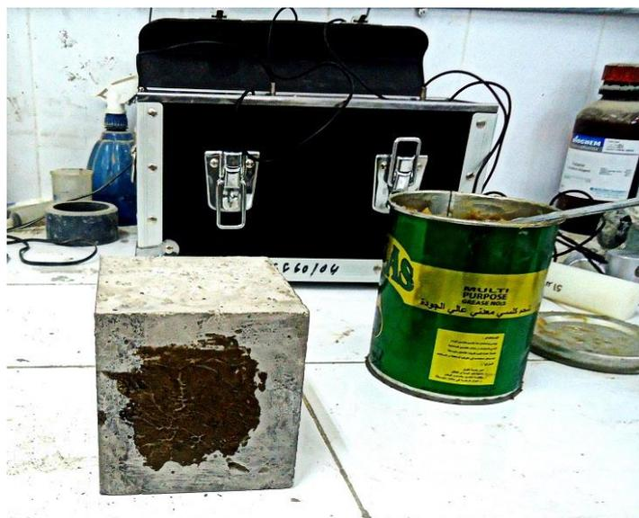
*Figure 2.17 : Graissage des faces d'éprouvette avec la vaseline.*
