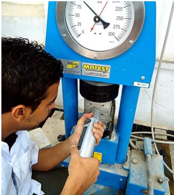
*Figure 2.19: Mesure de l'indice de rebondissement par le scléromètre.*
