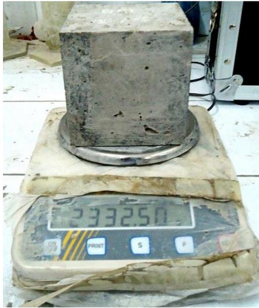
*Figure 2.14: Pesage des éprouvettes.*
