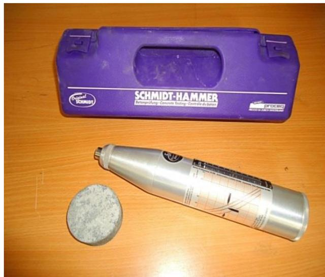
*Figure 2.5 : Appareil du scléromètre utilisé.*
