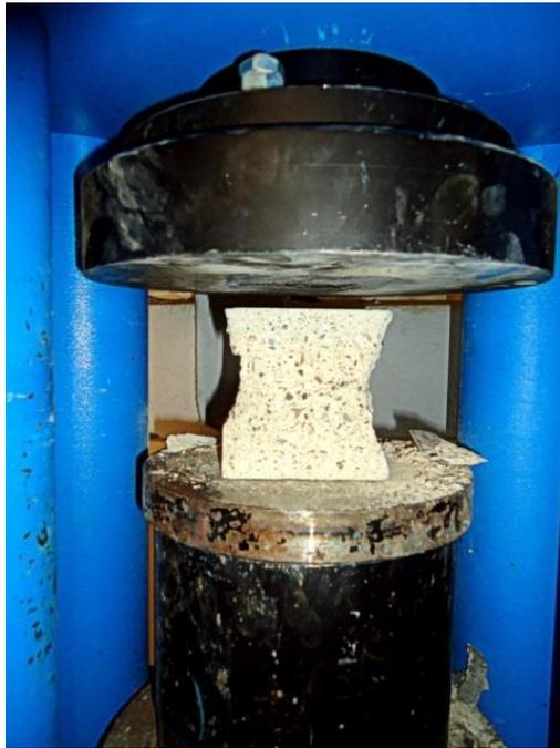
*Figure 2.20 : Essai d'écrasement à la compression*
