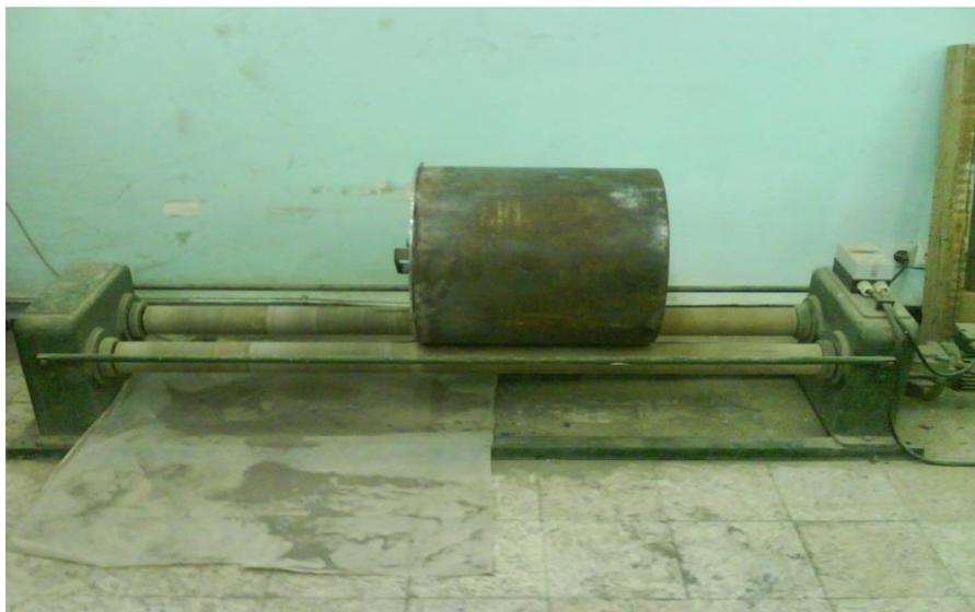
**Figure 2.4:** Broyeur à boulets.
