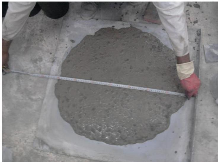
*Figure 2.10: essai d'étalement au cône d'Abrams*
