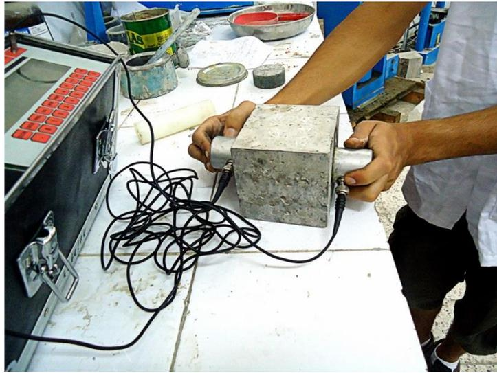
*Figure 2.18 : Mesure du temps de parcours des ondes ultrasonores*
