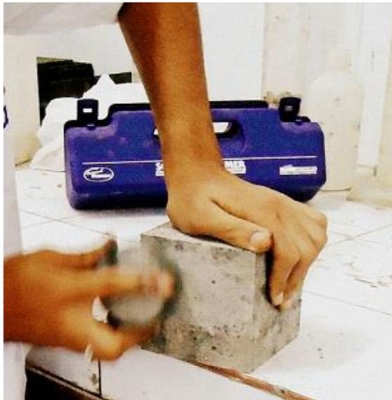
*Figure 2.15 : Ponçage des éprouvettes à l'aide de la pierre abrasive.*
