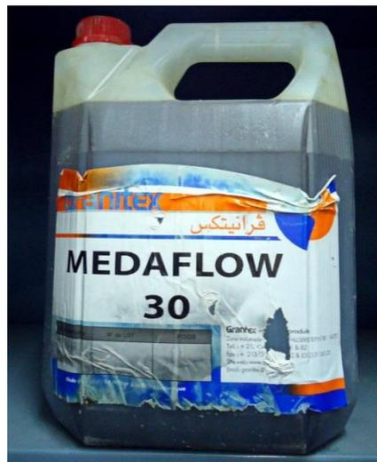
*Figure 2.2 : Le superplastifiant utilisé*
