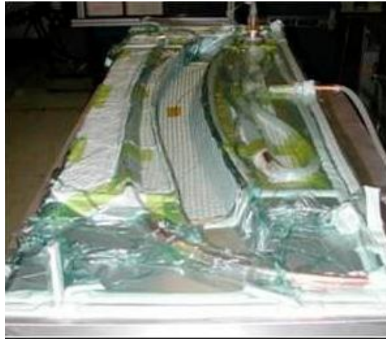
Figure (II.05) : injection de la résine sur un moule
