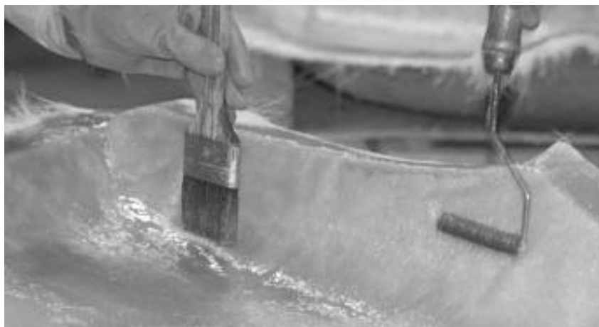
Figure (II.04) : technique de moulage au contact
