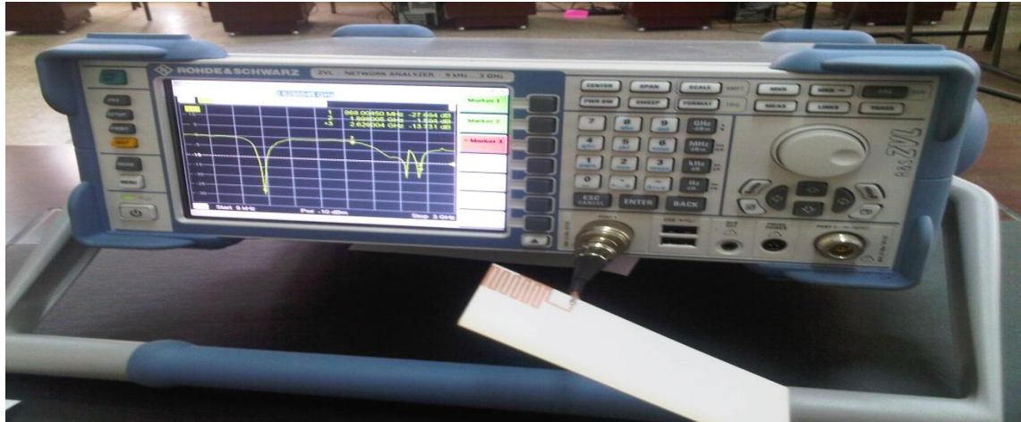
Figure 3.28: Photographie montrant la mesure de l'antenne
