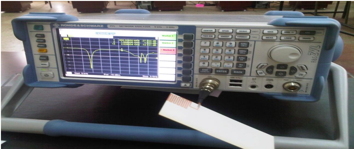
Figure 3.28: Photographie montrant la mesure de l'antenne
