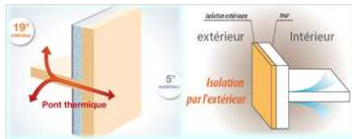
Fig.21 : Parois isolés par extérieur et intérieur
