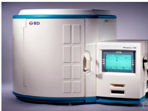
Figure12 : L'automate Phoenix (Becton Dickinson) [10]
