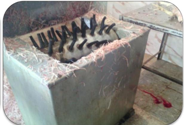
d- Plumeuse mécanique
