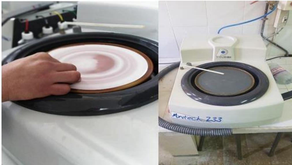
**Figure III.2 :** Polisseuse utilisée lors de la préparation métallographique.
