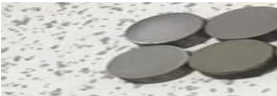
**Figure III.3 :** échantillons en acier après polissage.
