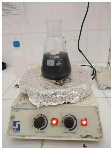
**Figure III.10 :** Agitateur magnétique.
