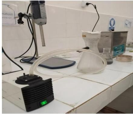
**Figure III. 11 : système de filtration**
