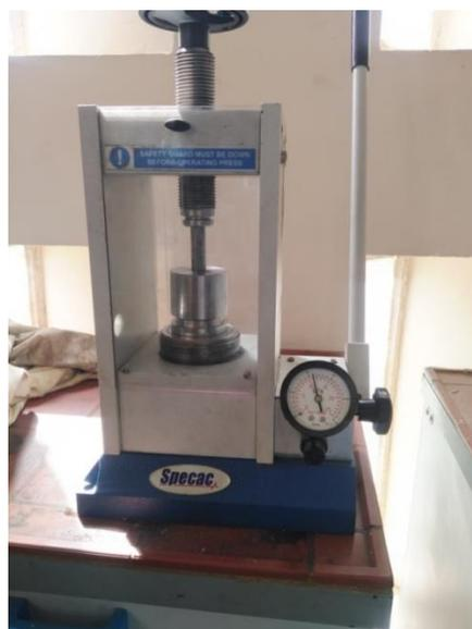
Figure III.5 : le dispositif utilisé pour le compactage
