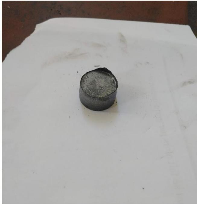
**Figure III.6** : l'échantillon de phase max après le compactage
