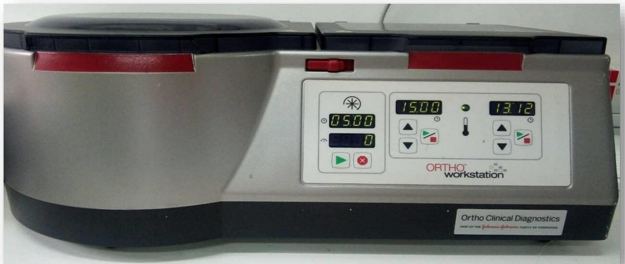
Figure10 : Incubateur – centrifugeuse pour les cartes a gel
