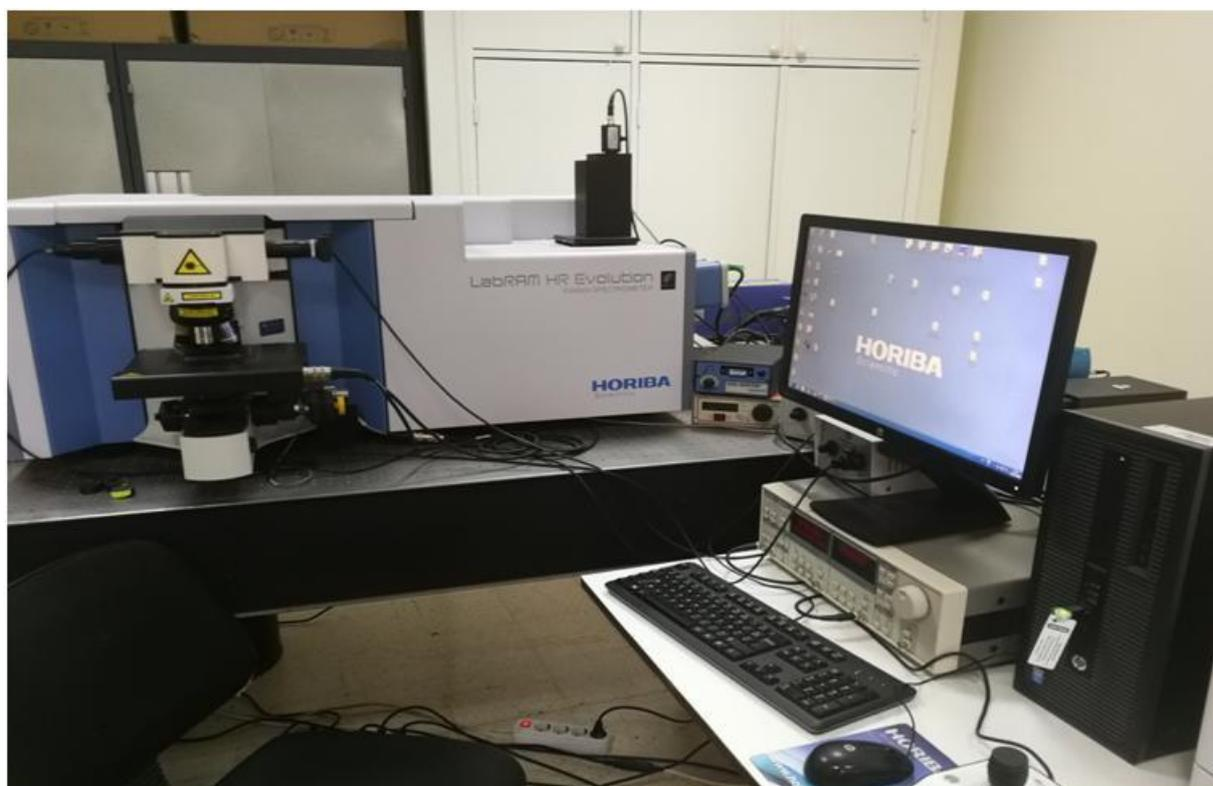
**Figure 27 : Photo du spectromètre Raman**
