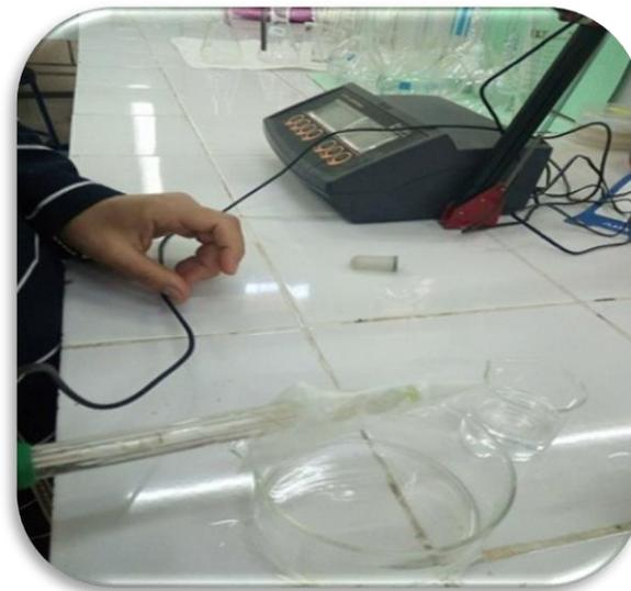
**Figure 24 : Mesure du pH de surface**
