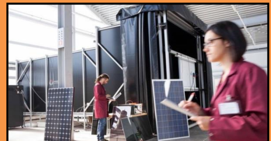
Figure 69 La chambre climatique
