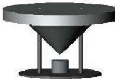
Figure 3.6 : émetteur ultrasonique et son cône de réflexion
