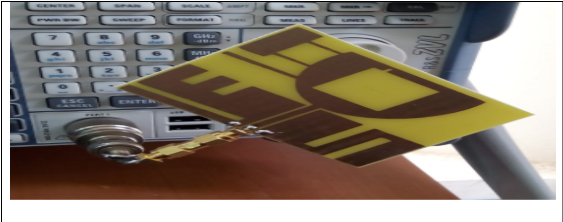
Figure 3.29 : La mesure de l'antenne en liaison directe.
