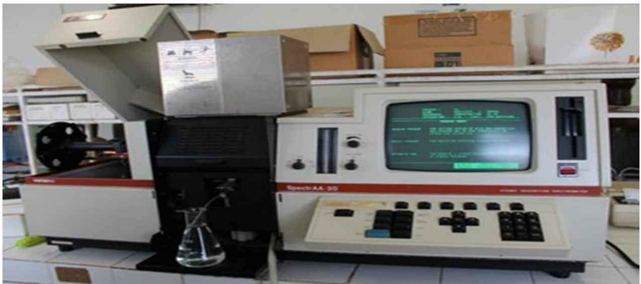
Figure 8: appareil de spectrophotométrie d'absorption atomique (SAA)( http://lenoni.e-monsite.com/ )
