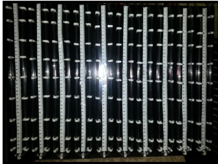
Fig. III.21 Tableaux multi manomètres
