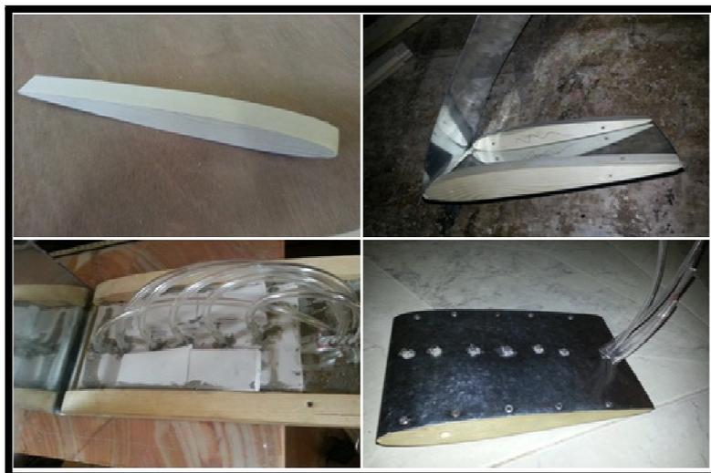
Fig. III.22 Profil NACA 0012 avec capteur
