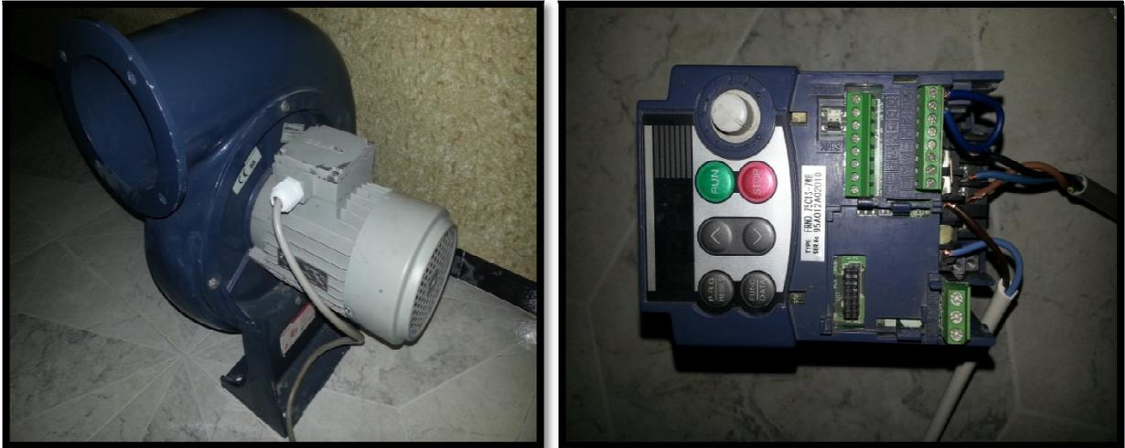
Fig. III.16 Le moteur et le variateur utilisés
