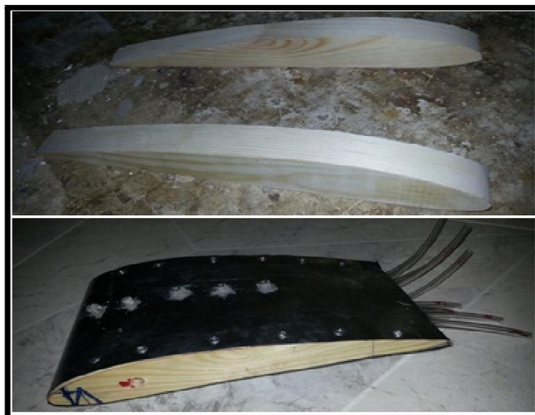
Fig. III.23 Profil NACA 4412 avec capteur
