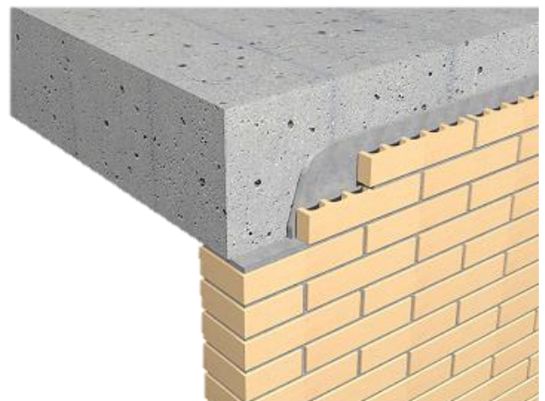
Figure 226 : Revêtement avec brique coupée, placée avec mortier a haute adhérence (169)
