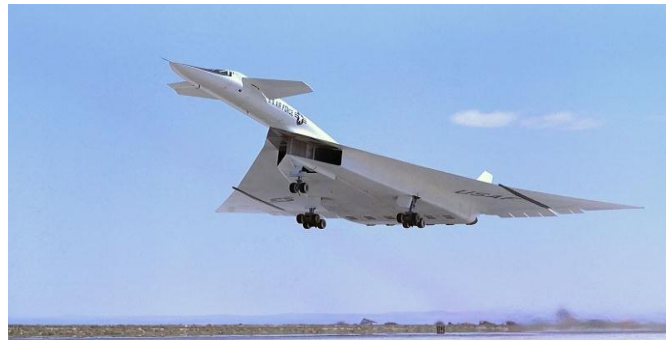
Figure (I.6) : l'avion XB-70 avec un système de control actif à la partie avant de l'avion
