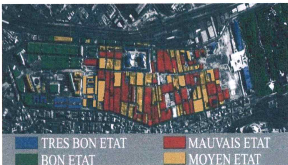
Carte n°22 : Lecture d'état du bâti au niveau d'El Hamma , auteur 2015
