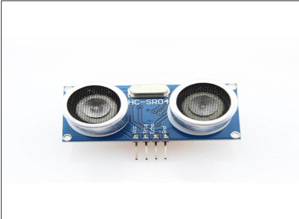
*Figure 4.12.* Capteur ultrason hc-sr04.
