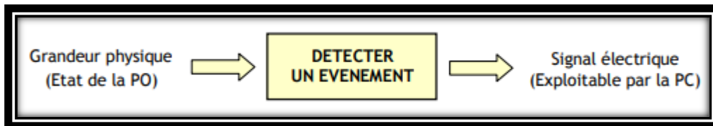
Figure 1. 1 : Rôle général d'un capteur
