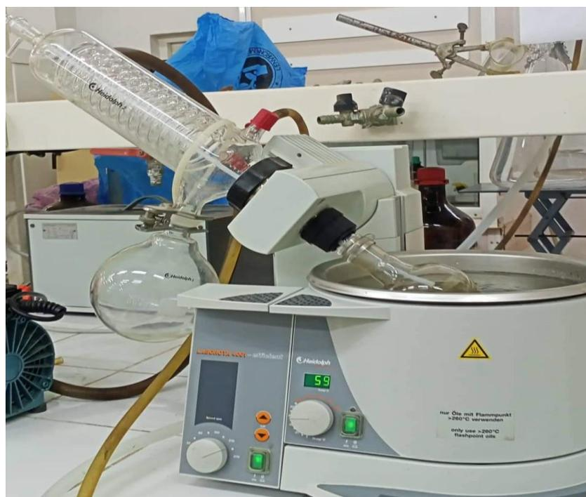
Figure 23 : Evaporation du solvant à l'aide d'un évaporateur rotatif
