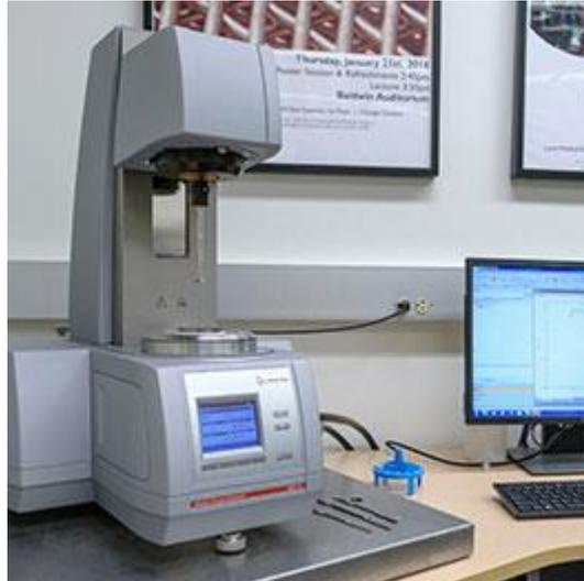
Figure29 : Rhéomètre ANTON PAAR PHYSICA RHEOLAB MCR 302
