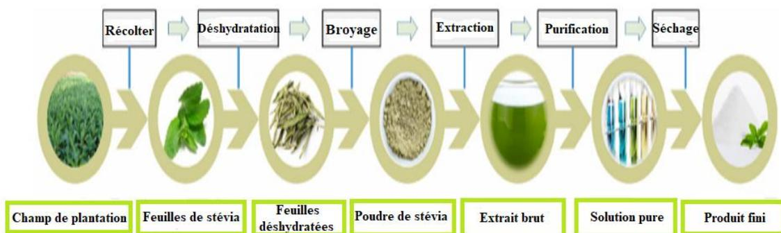
**Figure II.4** : Le processus de fabrication de la *stévia rebaudiana*.
