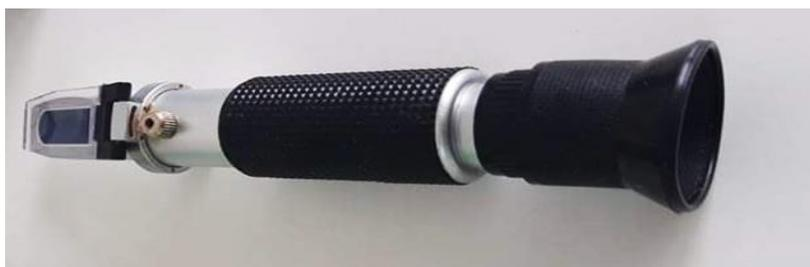
Figure IV.6: Un réfractomètre portable (photo originale).
