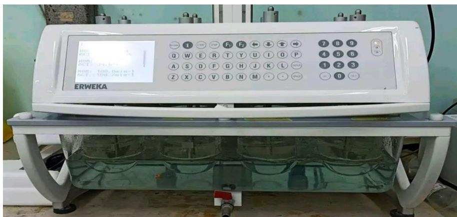
**Figure IV.7:** Un dissolutest à palette tournante (photo originale).
