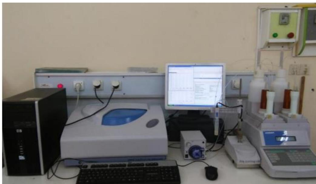
**Figure IV.5 :** Equipement de la diffusion dynamique de la lumière (DLS) (photo originale).
