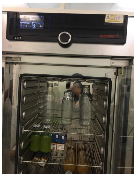
Figure 25 Dépôt des bouteilles dans l'étuve à 40°C pendant 10 jours.
