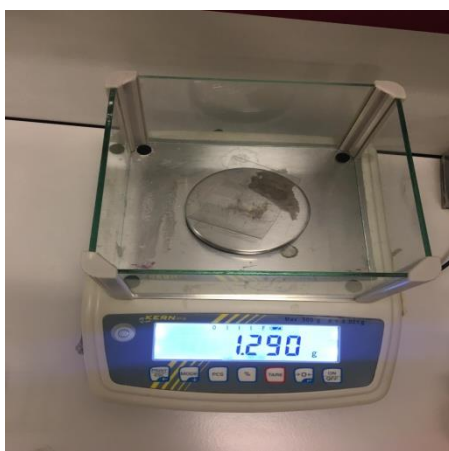
Figure 23 Pesée des éprouvettes
