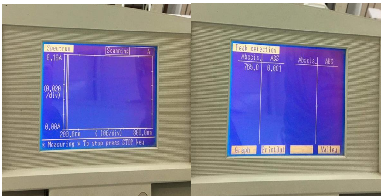
Figure 48 Analyse des simulants par spectrométrie UV-Visible avant et après essai de migration
