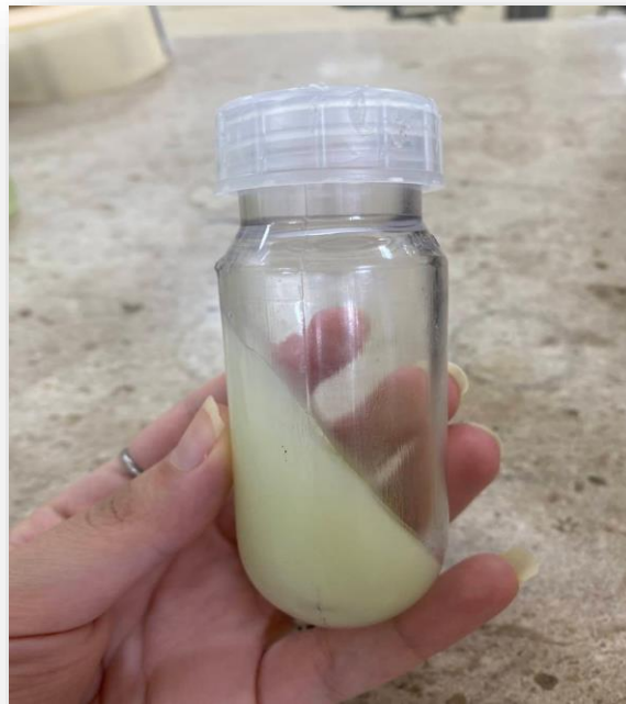
Figure N° 40 : Contrôle de stabilité par test de centrifugation (Photo personnelle, 2022)
