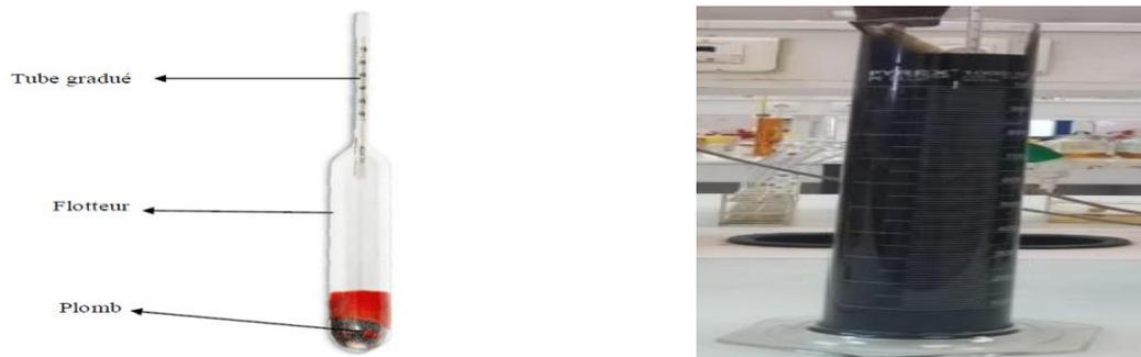
Figure II.2 : Mesure de la densité
