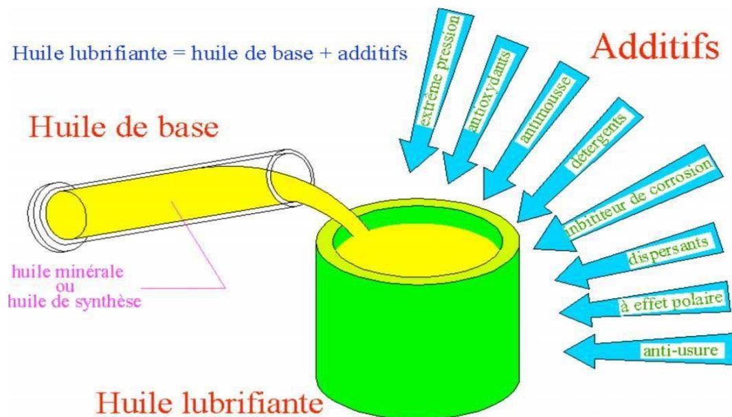
Figure I.1:Principe de composition d'une huile [8]
