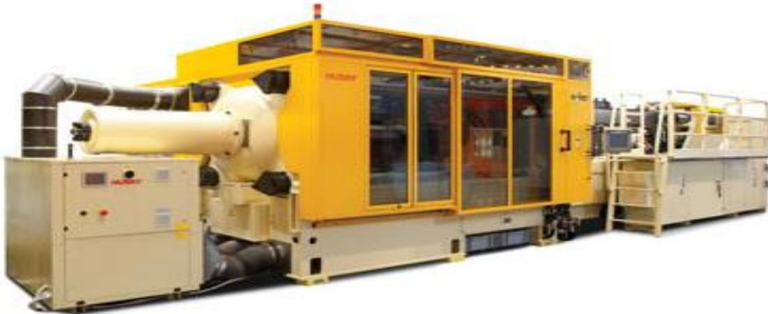
Figure. II.11 : Machine Husky injection plastique
