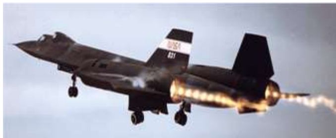
(a) Tuyère en sur-détente avec décollement étendu.
