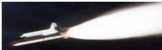
(b) Éclatement des jets des boosters de la Navette Spatiale à haute altitude.
