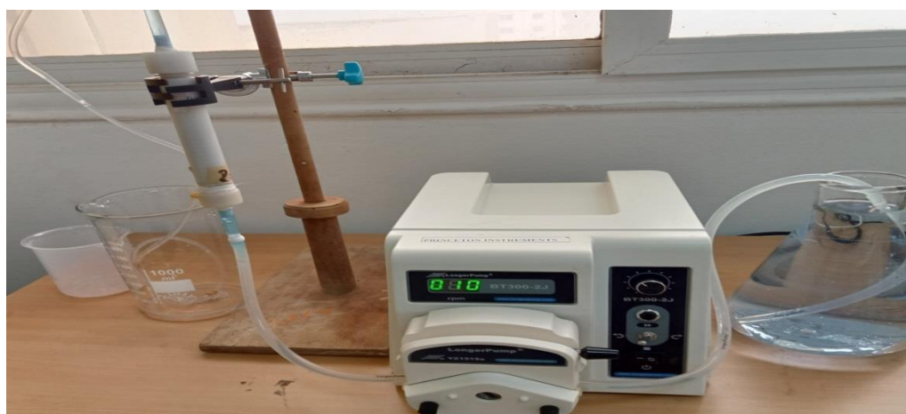
Figure I.1: Image montrant le dispositif utilisé dans la biosorption de polluant sur colonne fixe.
