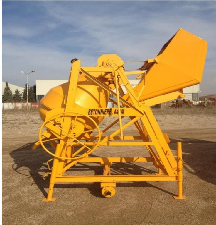
**Figure 1. 4: bétonnière fixe**
