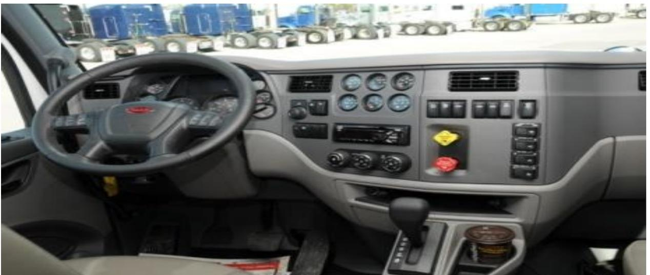
Figure 2. 9: Tableau de bord d'un camion malaxeur moderne
