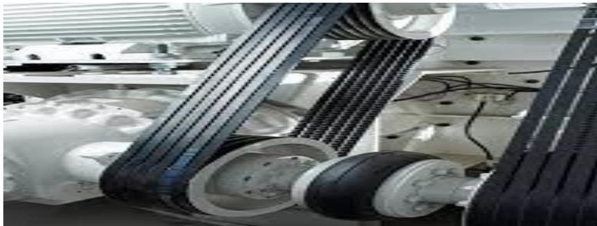
Figure 4. 5: La courroie de la centrale à béton
