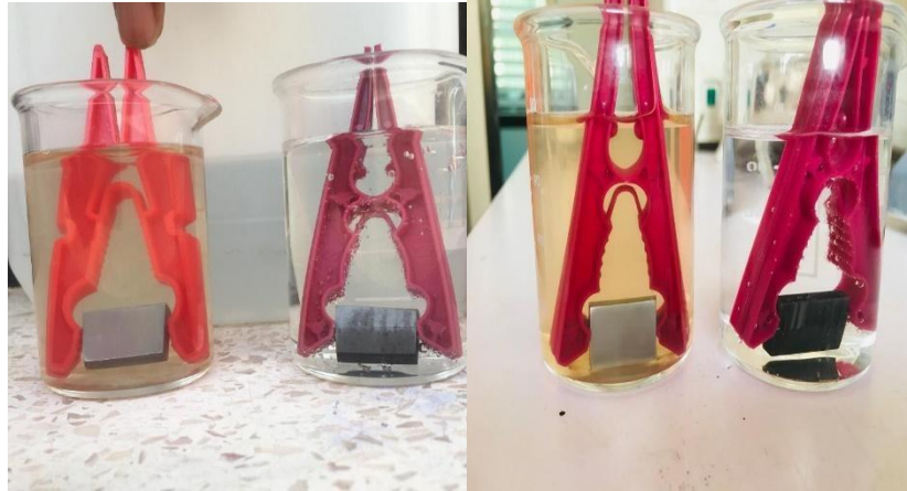
Figure 2.16. Echantillon de l'acier X70 immergé dans une solution avec et sans inhibiteur.
