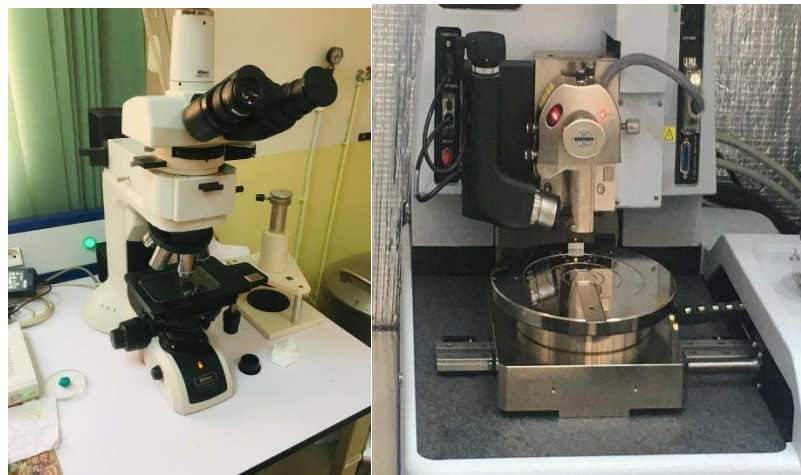
Figure 2.17. Microscope optique et un microscope à force atomique (AFM).
